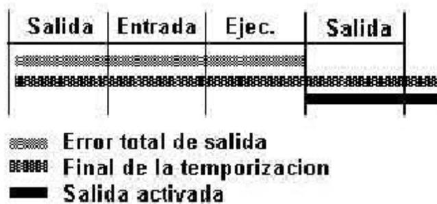
Fig. 80 – Diagrama error de salida.
