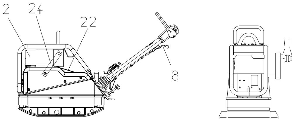
1. Girar la palanca del acelerador (8) a su posición máxima.
