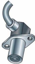
Sensor inductivo que emite una señal alterna ante el paso de los dientes de la corona del volante y la UCE puede obtener información de r.p.m. y PMS.
