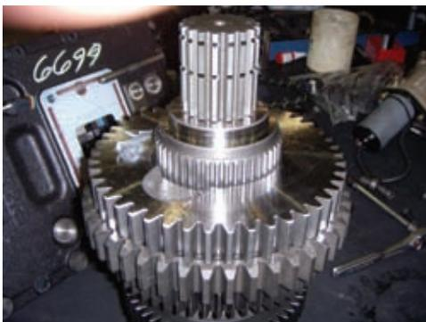
20. Instale o cubo da embreagem com a chanfradura voltada para cima.
