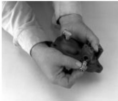
7. Lubrifique levemente a válvula de distribuição com lubrificante de silicone P/N 71206 da Eaton® Fuller® ou equivalente. Instale a válvula de distribuição com o lado plano voltado para dentro. Instale a porca de retenção da válvula e aperte com um torque de 40-50 Lb•ft.
