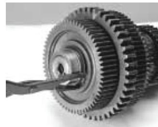
7. Use um acionador flangeado ou pressione para instalar a pista interna do rolamento na parte da frente do contraeixo contra a engrenagem de acionamento.
