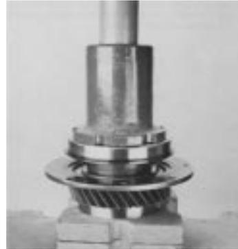
3. Instale o anel elástico na ranhura do cubo da engrenagem para fixar o rolamento.
