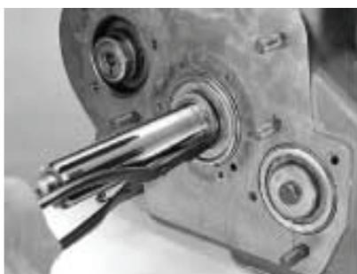
6. Instale o anel elástico de retenção do eixo piloto.
