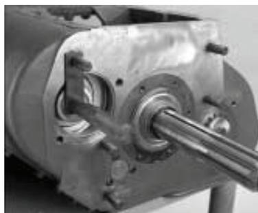
2. Insira a ferramenta do gancho do eixo principal ou um cabo de aço em volta do eixo principal.
