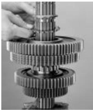
17. Posicione outro espaçador contra a engrenagem posicionada anteriormente, engatando as estrias externas do espaçador com os dentes da embreagem da engrenagem.
