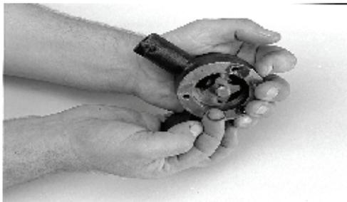
6. A partir do eixo de acionamento, remova o elemento interno da bomba de óleo.
