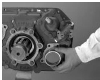
7. Remova a pista do rolamento do contraeixo auxiliar do orifício.
