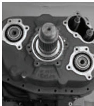
24. Aqueça o rolamento cônico traseiro e instale sobre o eixo de saída.
