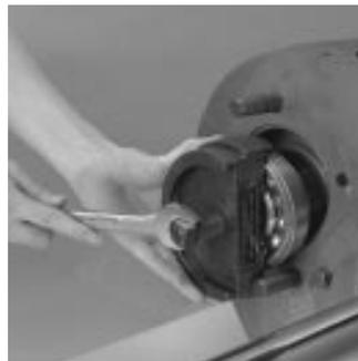
8. Movimente a frente do contraeixo para centralizar a caixa e levante o conjunto do contraeixo.
