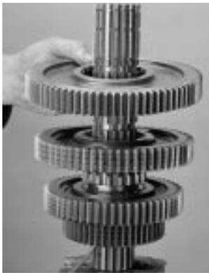
16. Com os dentes da engrenagem para cima, instale a próxima engrenagem no eixo contra a engrenagem posicionada anteriormente.
