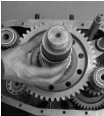
6. Instale o eixo de saída montado (veja Montagem do eixo de saída) entre os contraeixos e combine as marcas de sincronização.
