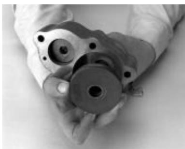
8. Remova os pistões de marcha e redução dos orifícios do cilindro.
