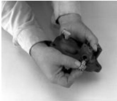
7. Lubrifique levemente os anéis O da válvula de distribuição com lubrificante de silicone N/P 71206 da Eaton® Fuller® ou equivalente. Instale a válvula de distribuição com o lado plano voltado para dentro. Instale a porca de retenção da válvula de distribuição e aperte com um torque de 40 a 50 Lb•ft.
