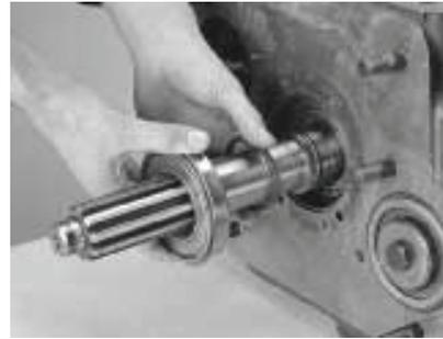
8. Instale o rolamento do eixo piloto sobre o eixo piloto. Use um acionamento de rolamento com a extremidade flangeada que entra em contato com as pistas interna e externa do rolamento. Gire o rolamento até ele entrar em contato com a caixa dianteira.
