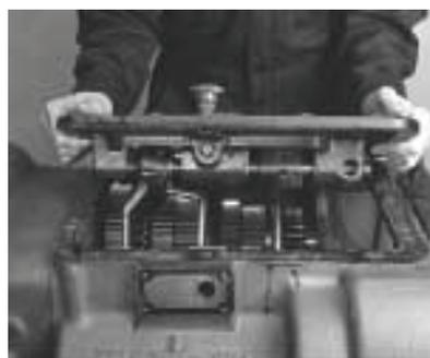
9. Se os 3 (três) conjuntos de molas de tensão e esferas dos orifícios superiores do alojamento estiverem frouxos, incline o conjunto e remova-os.
