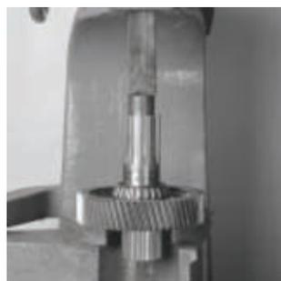
11. Use a superfície frontal da engrenagem de redução como base, pressione o eixo de saída através do rolamento e da engrenagem. Isso libera o rolamento, a engrenagem de redução, a arruela e a arruela estriada.
