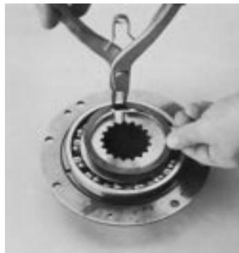
4. Instale o anel de retenção externo, com o lado sulcado para baixo (introduzir) com um acionador flangeado.
