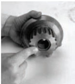
3. Monte a engrenagem de marcha baixa no acoplador e instale as buchas, se foram removidas.
