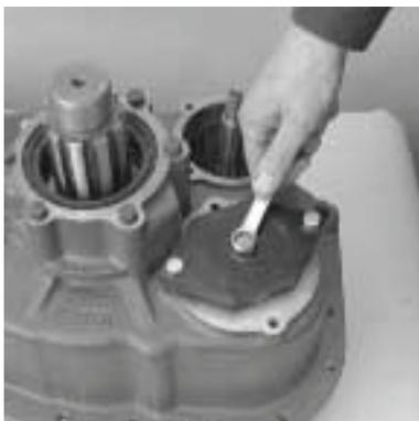
16. Instale a cinta de retenção do contraeixo auxiliar com 2 parafusos 23/8" NC x 1" e 3/8" NC x 21/2" limpos.
