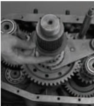
14. Instale a arruela escalonada sobre o eixo principal auxiliar com o lado escalonado para cima.
