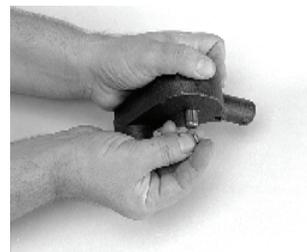
11. Alinhe o rasgo de chaveta da engrenagem de acionamento com a chaveta do eixo de acionamento e instale a engrenagem de acionamento no eixo de acionamento.
