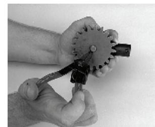
12. Instale o anel de retenção externo da engrenagem de acionamento na ranhura do eixo de acionamento.
