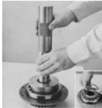
5. Instale o conjunto da engrenagem de transmissão auxiliar na parte traseiro do eixo principal. Use o acionador com a extremidade flangeada para assentar completamente o conjunto no orifício da caixa.
