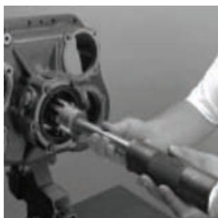
9. Use uma barra flexível e um martelo para mover o eixo de saída completamente para frente e através do conjunto do rolamento traseiro.
