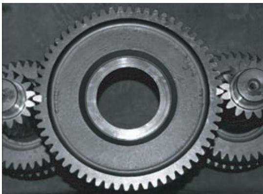
4. Use uma barra ou lixa redonda para realizar o alinhamento correto do dente marcado no contraeixo auxiliar à engrenagem do multiplicador auxiliar. Quando a barra estiver alinhada com a base, entre o dente correto, você observará que ela está paralela ao contraeixo auxiliar. Marque ambos os dentes com uma tinta bem visível.
