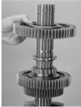
15. Com os dentes da engrenagem para baixo, posicione a próxima engrenagem no eixo principal prendendo-a com as estrias externas do espaçador.
