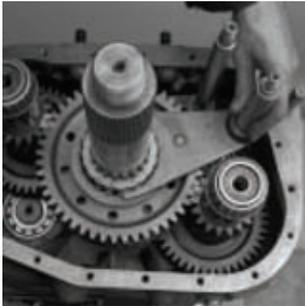
13. Instale o garfo de super-redução dentro da fenda na embreagem deslizante de super-redução. Certifique-se de que o posicionamento esteja correto.
