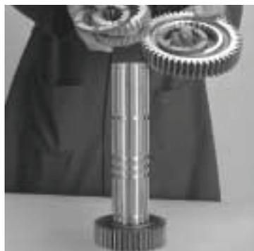
6. Remova a arruela de compensação e a embreagem deslizante e, em seguida, remova a arruela de compensação e a 3ª engrenagem.
