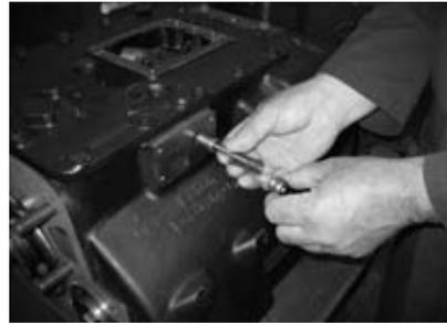
7. Instale a servo-válvula. Aplique Loctite 242 nas roscas dos parafusos e aplique torque de 8 a 12 lb-ft (10-85-16-30 N•m).
