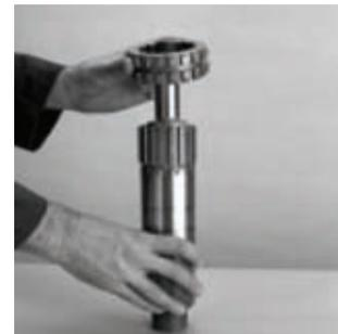
2. Marque, com a tinta do fabricante, dois dentes opostos na engrenagem de marcha baixa.
