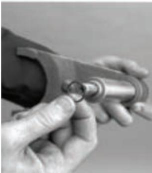
12. Instale o anel O ou a junta na extremidade do garfo de super-redução. **OBSERVAÇÃO:** As versões anteriores usavam a junta N/P 21338 com o pistão N/P 21337. Os modelos atuais usam um anel O N/P 4301348 com o pistão N/P 43013320. A junta ou anel O corretos devem ser instalados com os respectivos pistões.
