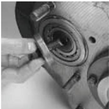
5. Remova o parafuso e a placa retentora dianteira da frente de cada contraeixo.
