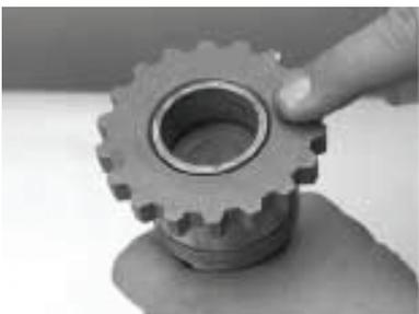
10. Inspeção a bucha na cavidade do eixo piloto e substitua se estiver danificada.
