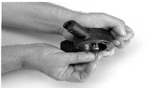
8. A partir do alojamento da bomba de óleo integral, remova o eixo de acionamento.
