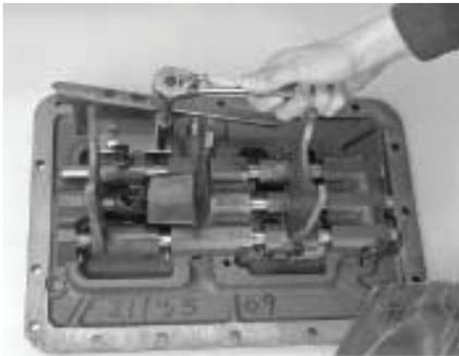
17. Instale o bloco de mudança e os parafusos de travamento do garfo de mudança com torque de 35-45 lb-ft (47.45-61.01 N•m). Trave-os firmemente com fio de segurança.
