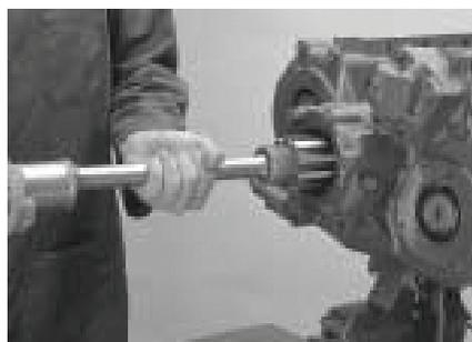
4. Use uma barra flexível e um martelo para mover o eixo de saída para frente, o suficiente para deslocar parcialmente o rolamento.
