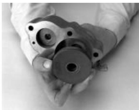
8. Remova os pistões de marcha e redução dos orifícios do cilindro.
