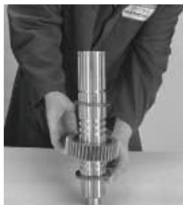
7. Remova a arruela plana, remova a 4ª engrenagem ou sobremarcha e remova a arruela de compensação.
