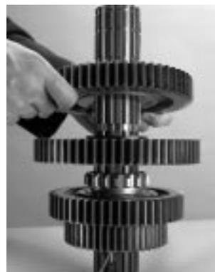
16. Posicione a arruela de compensação (com a superfície plana voltada para baixo) contra a engrenagem. Gire a arruela até que as estrias da arruela e do eixo principal estejam alinhadas.
