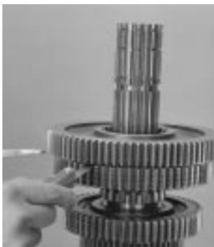
20. Insira duas chaves de fenda grandes entre as duas engrenagens. Aplique uma leve pressão para baixo para estender as engrenagens uniformemente. Entre o cubo da engrenagem e o espaçador do eixo principal, insira um calibrador de 0,006" e um calibrador de 0,015". Se estiver fora da tolerância, troque a arruela em frente ao espaçador do eixo principal. Consulte as informações antes dos procedimentos para obter mais informações.
