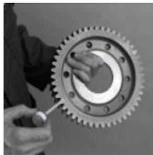
16. Instale a engrenagem de redução sobre o eixo principal auxiliar. Alinhe com os dentes marcados.
