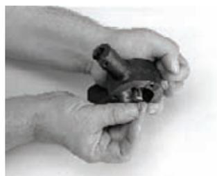
7. Instale as duas (2) chaves no eixo de acionamento.
