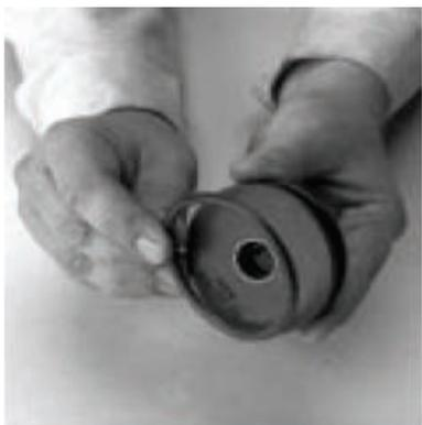
9. Se necessário, remova os anéis O do orifício do cilindro de marcha e do orifício do cilindro de redução.
