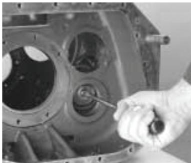
4. Da parte de trás da caixa, insira o eixo intermediário através do orifício do rolamento da caixa principal e no rolamento da engrenagem intermediária de reversão.
