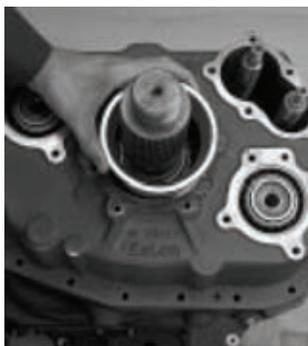
20. Instale o espaçador do rolamento interno.
