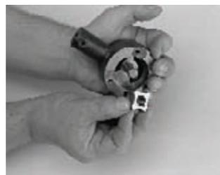
8. Alinhe os rasgos de chaveta do elemento interno com as chavetas do eixo de acionamento e instale o elemento interno da bomba de óleo.
