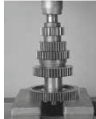
5. Alinhe o rasgo da chaveta da engrenagem da TDP com a chave do contraeixo, a parte cônica do dente voltada para cima (na traseira do eixo). Alinhe o rasgo da chaveta da engrenagem de acionamento com a chave do contraeixo, o cubo longa contra a engrenagem da TDP, e pressione as duas engrenagens no contraeixo.
