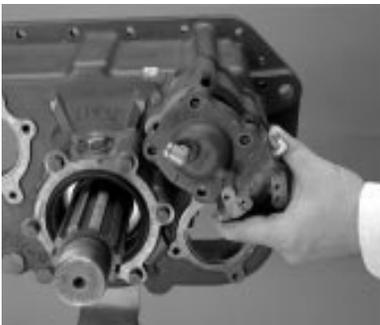
8. Instale a junta e a tampa. Aplique selante de rosca P/N 71205 da Eaton® Fuller® ou equivalente nas roscas do parafuso. Instale os parafusos e aperte com um torque de 35-45 Lb•ft.
