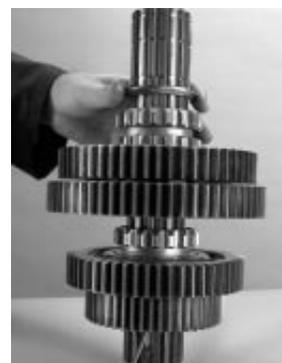
20. Na traseira do eixo principal, instale a chave do eixo principal na estria com a linha de ar. Remova a linha de ar da estria ao instalar a chave.
