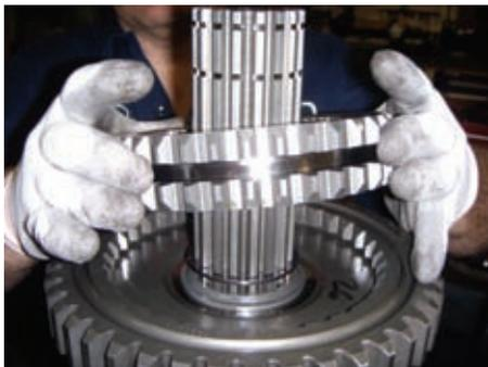
18. Instale o anel elástico na ranhura do eixo principal.
