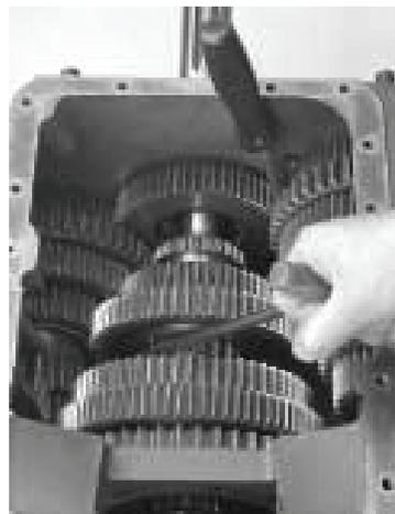
4. Incline o eixo principal para cima e levante o conjunto da caixa.
