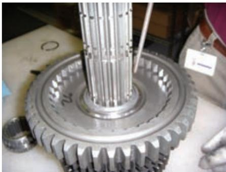
16. Posicione a arruela de compensação (com a superfície plana voltada para baixo) contra a engrenagem. Gire a arruela até que as estrias da arruela e do eixo principal estejam alinhadas.
