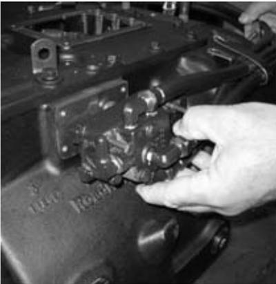
7. Instale a servo-válvula e aperte de acordo com as especificações.
