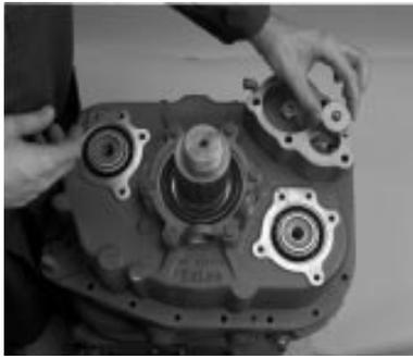
6. Instale o pistão de super-redução com o lado plano voltado para trás. Instale a porca e aperte com um torque de 50 a 65 Lb•ft.
