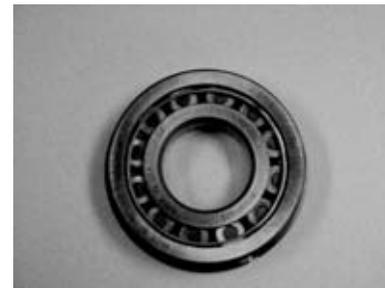
6. Use um acionador da extremidade flangeada para iniciar o rolamento dianteiro no orifício da caixa.
