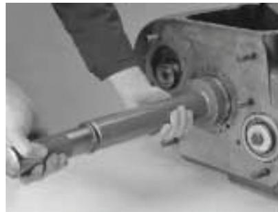
9. Instale temporariamente a tampa do rolamento dianteiro com dois parafusos.
