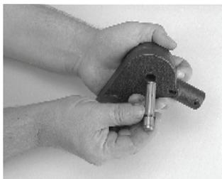
5. Se for removido, substitua o anel de retenção do eixo de acionamento no eixo de acionamento da bomba.
