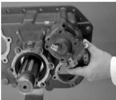
8. Instale a junta e a tampa. Aplique vedante de rosca N/P 71205 da Eaton® Fuller® ou equivalente nas roscas do parafuso. Instale os parafusos e aperte com um torque de 35 a 45 Lb•ft.
