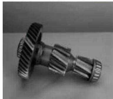
5. Instale os dois conjuntos do contraeixo. Faça com que marcas de sincronização na engrenagem de transmissão auxiliar combinem com as marcas de sincronização nos contraeixos.
