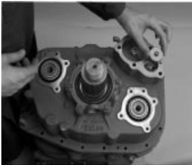
6. Instale o pistão de redução com o lado plano voltado para trás. Instale a porca e aperte com um torque de 50-65 Lb•ft.
