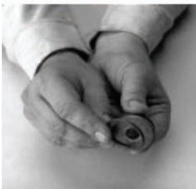
10. Se necessário, remova os anéis O dos diâmetros interno e externo do pistão de marcha e do orifício externo do pistão de redução.
