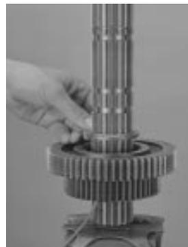
10. Insira duas chaves de fenda grandes entre as duas engrenagens. Aplique uma leve pressão para baixo para estender as engrenagens uniformemente. Entre o cubo da engrenagem e o espaçador do eixo principal, insira um calibrador de 0,006" e um calibrador de 0,015". Se estiver fora da tolerância, troque a arruela em frente ao espaçador do eixo principal.
