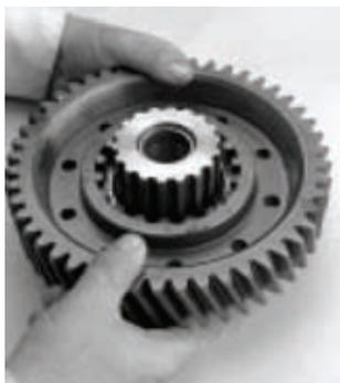
5. Monte a engrenagem sobre o acoplador.
