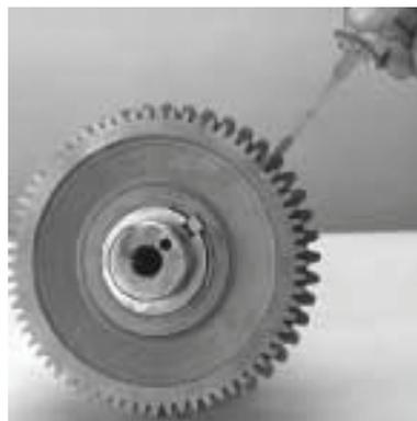
2. Coloque o contraeixo da engrenagem de 47 dentes da TDP dentro da caixa principal com o eixo assentado nos orifícios inferiores da caixa do contraeixo.
