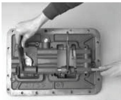
7. Instale o parafuso de travamento do garfo de mudança com torque de 35-45 lb-ft (47.45-61.01 N•m). Trave-o firmemente com o fio de segurança.
