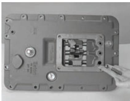
19. Instale as três esferas de tensão, uma em cada orifício superior do alojamento. Instale as três molas do ressalto, uma sobre cada esfera de tensão.
