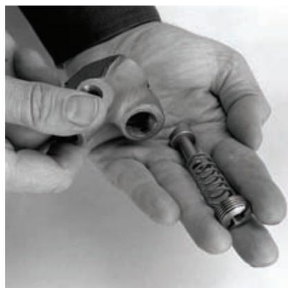
10. Inspeccione as peças do garfo e do bloco e substitua as peças desgastadas.
