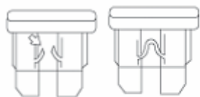
Fusible fundido Fusible normal
