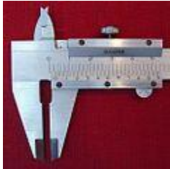
Pie de rey o calibre vernier.
