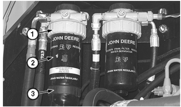
1—Anillo retenedor 2—Separador de agua 3—Tazón de sedimentos
