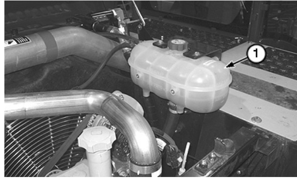
1—Tanque de rebose
