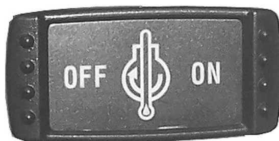
Conmutador del auxiliar de arranque con éter
