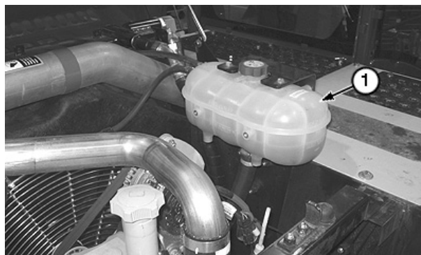
1—Tanque de rebose
