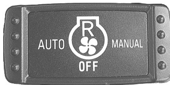
Conmutador de inversión del ventilador de enfriamiento
