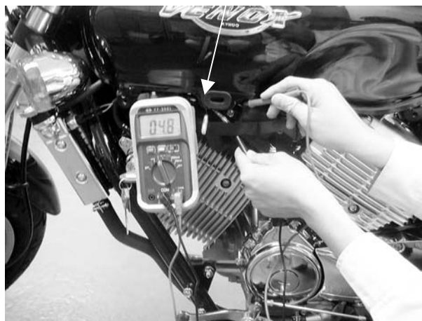
Bobina de alta tensión
