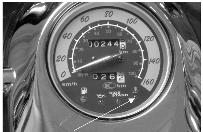
Testigo de sobrecalentamiento
