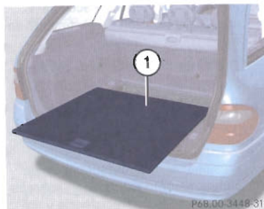
Introducción del piso del compartimento de carga
