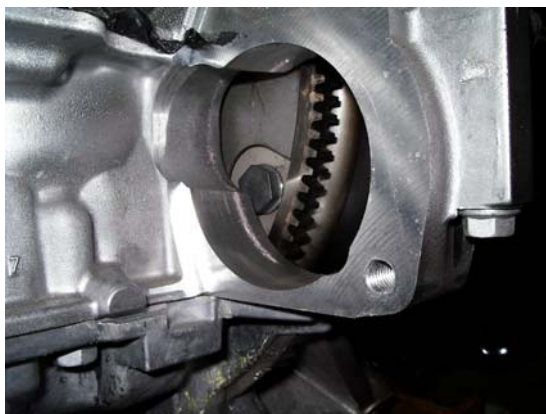
Foro per l'estrazione delle 3 viti del convertitore
