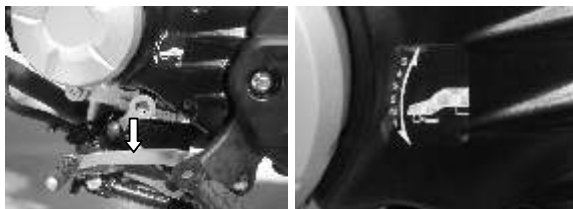
Pedal de Cambios y Secuencia de Velocidades
