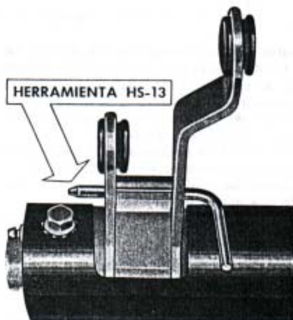
Fig. 130. — Ajuste de la caja selectora de cambios del "Rambler" con la herramienta HS-13.
