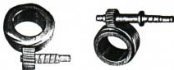
Fig. 102. — 1) Sinfin y Piñón de Velocímetro, para vehículos Simple Tracción (en Caja de Velocidades). 2) Sinfin y Piñón de Velocímetro para vehículos Doble Tracción (en Caja de Transferencia).
