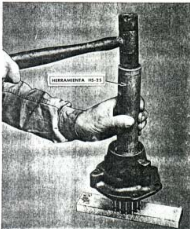
Fig. 299. - Instalando el cono de cojinete del eje de salida trasero.
