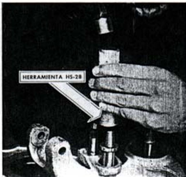
Fig. 175. — Instalando un retén de aceite de barra de cambios, con la herramienta HS-28.
