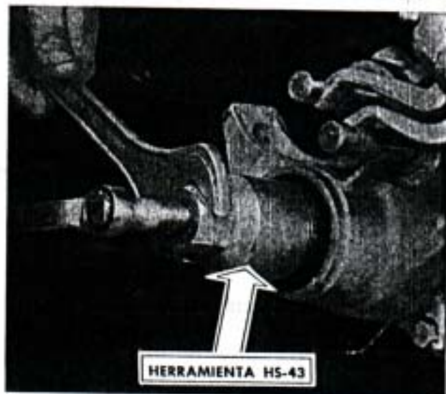
Fig. 144. — Extrayendo el retén de aceite de la extensión delantera, con la herramienta HS-43.
