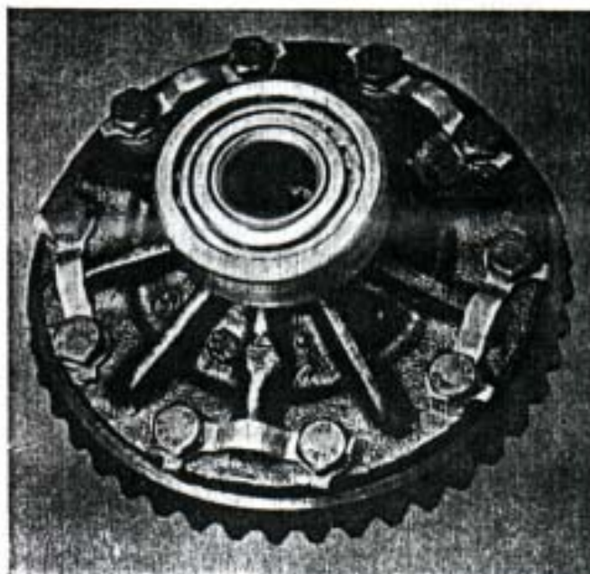
Fig. 240. — Detalle de la caja del diferencial, un cojinete y las trabas de seguridad para los bulones de la corona.
