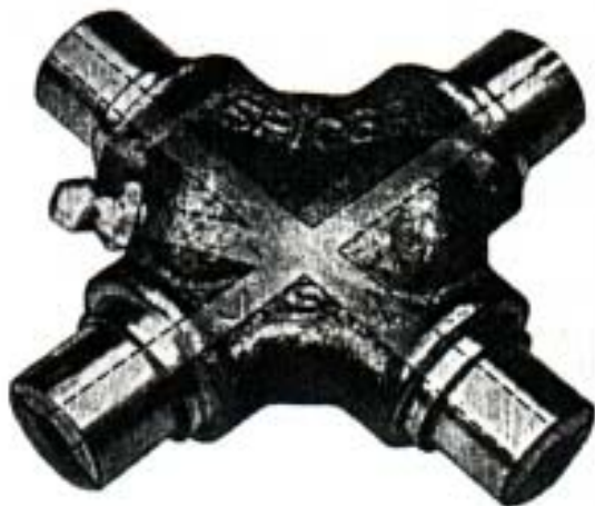
Fig. 187. — Cruceta. Disposición de los canales internos para lubricación de los cojinetes a agujas.
