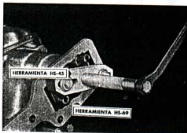
Fig. 143. — Extrayendo la brida de acoplamiento delantera, con las herramientas HS-45 y HS-69.
