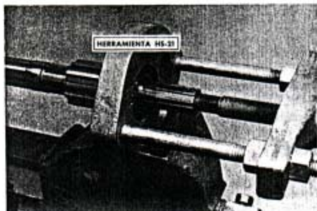
Fig. 152. — Extrayendo el cono del cojinete a rodillos del eje principal, con la herramienta HS-21.
