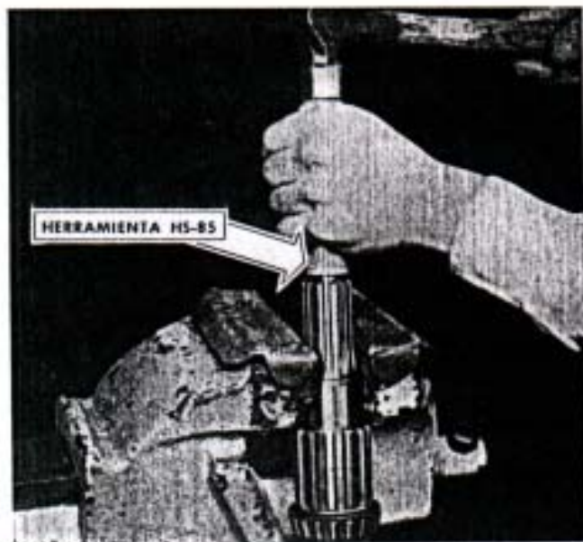
Fig. 162. — Instalando el buje piloto del eje principal, con la herramienta HS-85.
