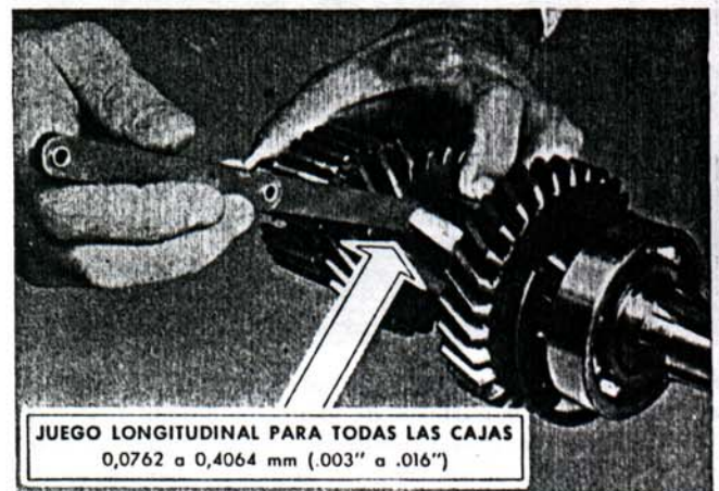
Fig. 98. — Verificando el juego longitudinal de la maza del sincronizador y el engranaje de 2da., contra el respaldo del eje principal.
