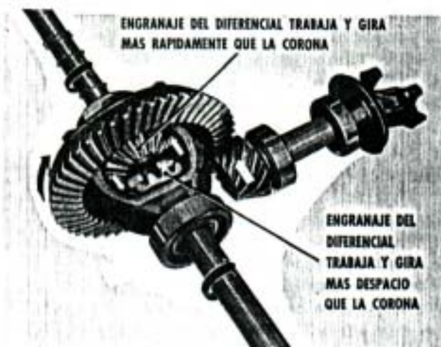
Fig. 198. — Funcionamiento del diferencial y del engranaje de mando del puente trasero, cuando el "vehículo dobla una esquina".
