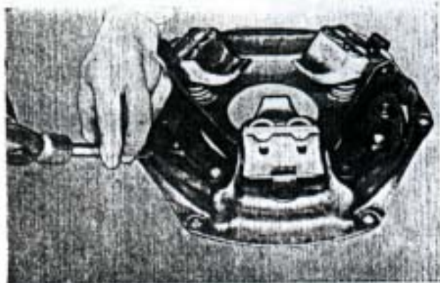
Fig. 33. — Marcando placa y cubierta con un punto, previo al desarme del embrague.
