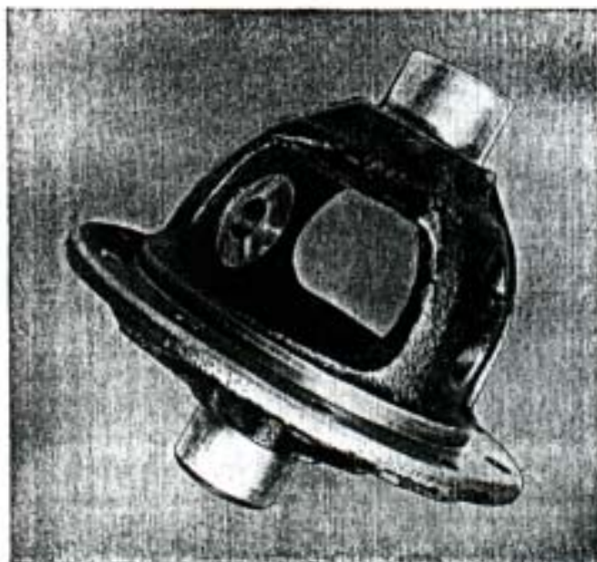
Fig. 221. — Vista de la caja del diferencial.
