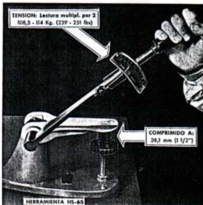
Fig. 22. — Verificando la tensión de los resortes del embrague modelo 1304.
