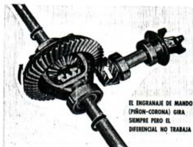
Fig. 195. — Funcionamiento del diferencial y del engranaje de mando del puente trasero, con el vehículo "marchando en línea recta".
