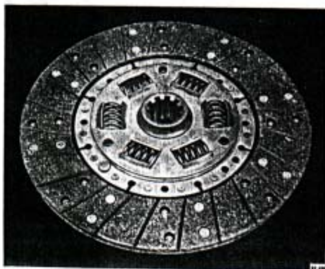
Fig. 3. — Disco de embrague.
