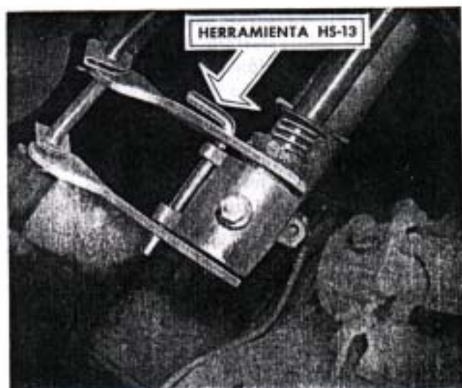
Fig. 124. — Verificando el ajuste de la Caja Selectora de Cambios, con la herramienta H5-13.
