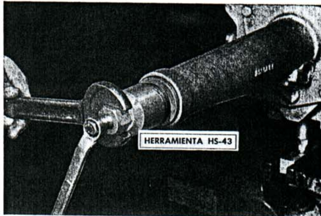
Fig. 89. — Extrayendo el retén de aceite de la extensión trasera, con la herramienta HS-43. Caja nacional para "Carabela", "Bergantín" y "Baqueano".
