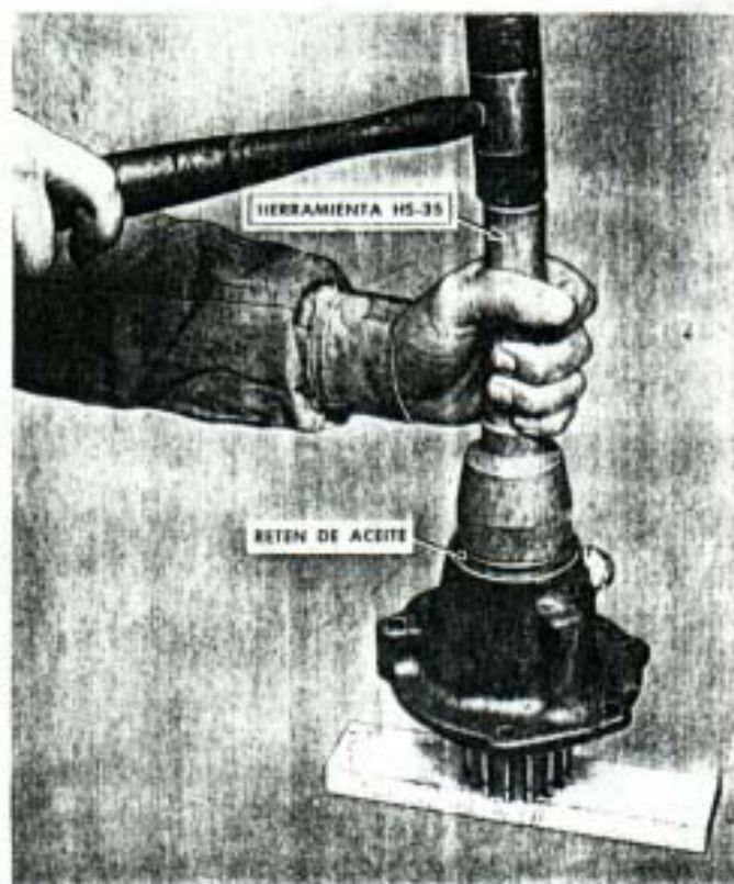
Fig. 302. - Instalando el retén de aceite en la extensión de salida trasero, con la herramienta HS-35.
