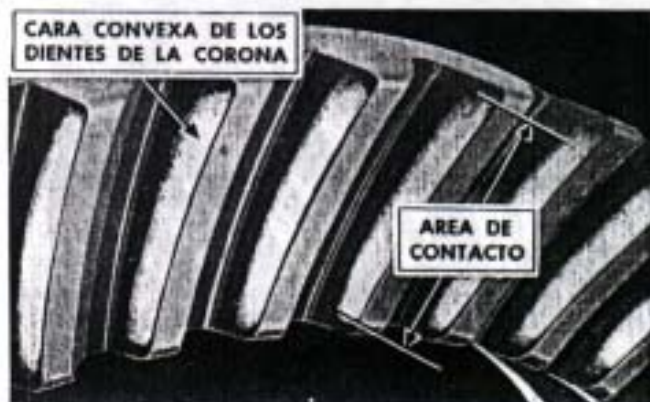
Fig. 247. — Correcto contacto entre dientes.
