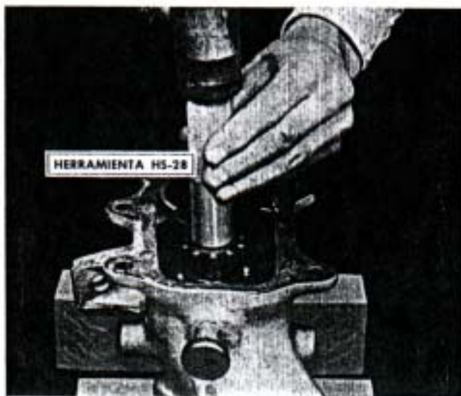
Fig. 160. — Instalando el eje de salida delantero, con el manguito de la herramienta HS-28.
