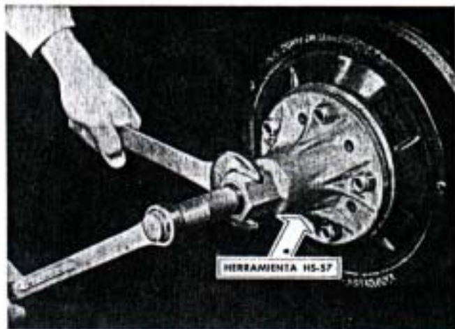
Fig. 201. — Extrayendo la maza y campana de frenos con la herramienta HS-57.
