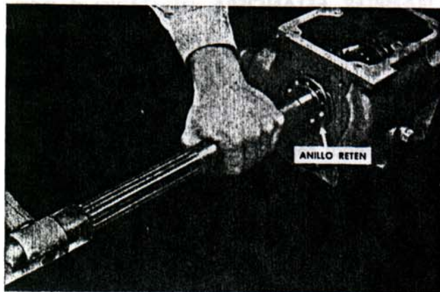
Fig. 94. — Liberando el eje principal de su cojinete. Caja importada para "Carabela".
