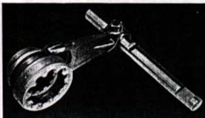
Fig. 171. — Posición de montaje del manguito de acople en su horquilla correspondiente, con respecto a la barra de cambios.
