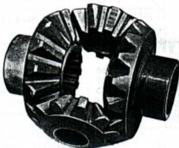
Fig. 222. — Detalle de engranajes y piñones del diferencial.
