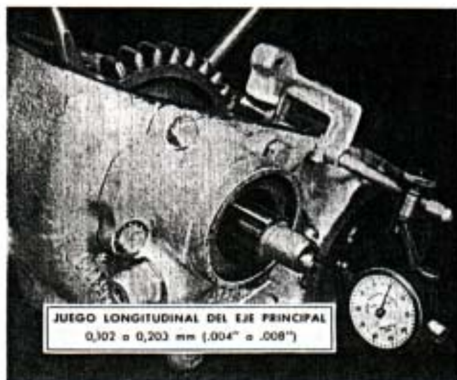
Fig. 159. — Verificando el juego longitudinal del eje principal.
