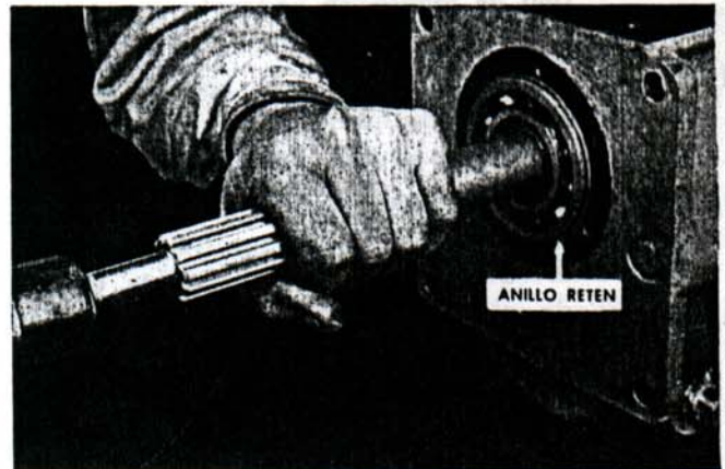
Fig. 91. — Extrayendo el engranaje de mando. Caja nacional para "Rambler", "Carabela", "Bergantín" y "Baqueano".
