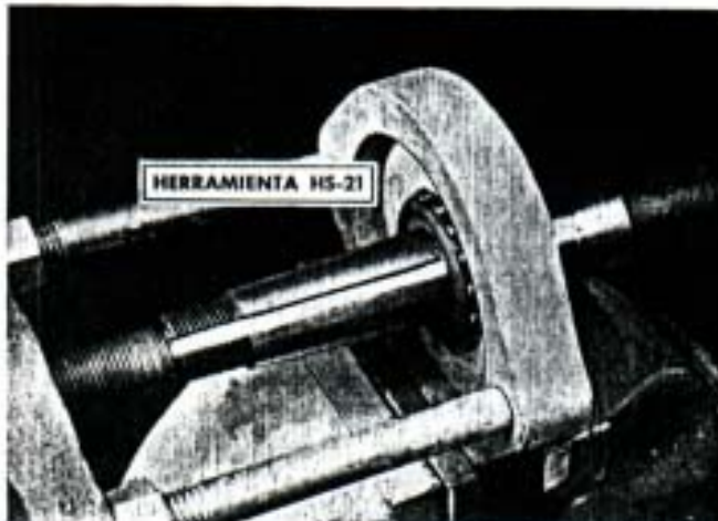
Fig. 204. — Extrayendo el cono de un cojinete de semieje trasero, con la herramienta HS-21.
