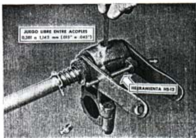
Fig. 126. — Verificando con una sonda el juego libre entre las caras de los acoples.
