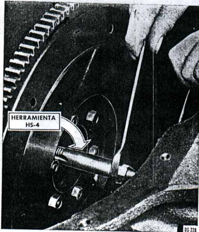
Fig. 78. — Extrayendo el buje piloto.
