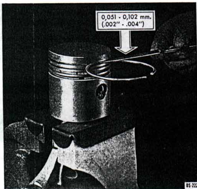
Fig. 71. — Verificando la luz entre aro y ranura.
