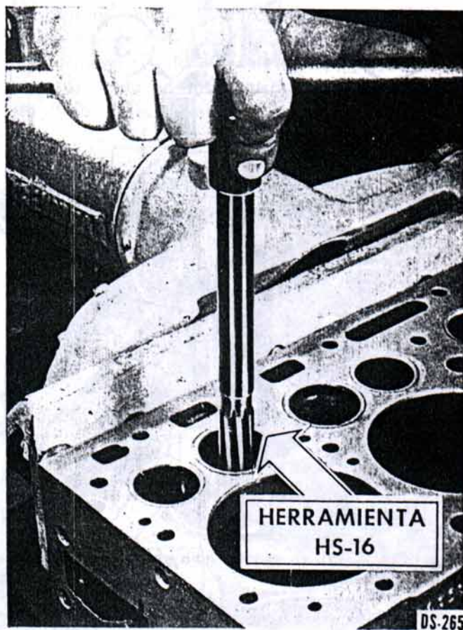
Fig. 122. — Escariando el alojamiento de la guía de válvula.
