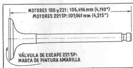
Fig. 35.— Diferencia de longitud entre las válvulas de los motores 188, 221 y 221 SP.
